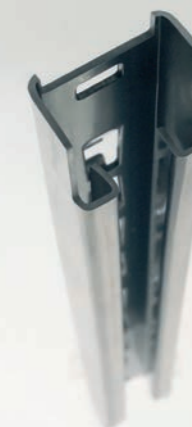
Edelstahl-Profil aus Federbandstahl. Die gewichtssparenden Lochungen werden prozessintegriert hergestellt, die Qualitätsprüfung erfolgt inline mit Lichtoptik (Foto 2)
