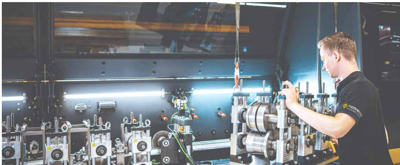
Die neue Konsolenbauweise erleichtert den Zugang und Werkzeugwechsel der Xellar-Anlagen.
